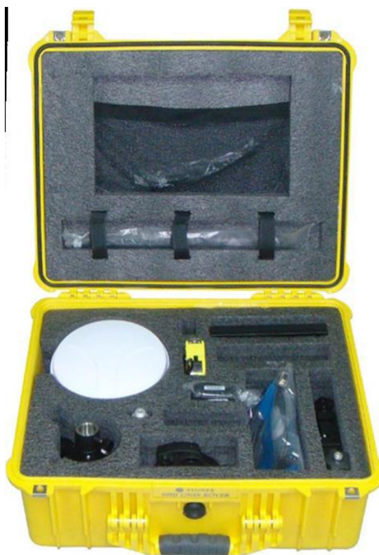
6 Сурет – GPS Stonex S9III plus қабылдағышының роверлік құрамының комплектациясы
